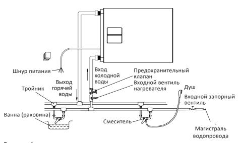
Внимание! Горизонтальная установка водонагревателя возможна только с выходом труб налево.
