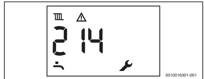
Рис. 71 Пример: неблокирующая неисправность
