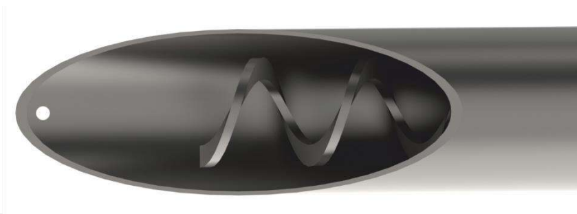
Рис.6. Монтаж спирали питателя.
