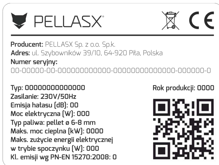
Рис. 3. Образец заводской таблички горелки.
