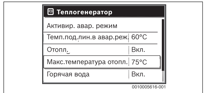
Рис. 24 Максимальная температура подающей линии
