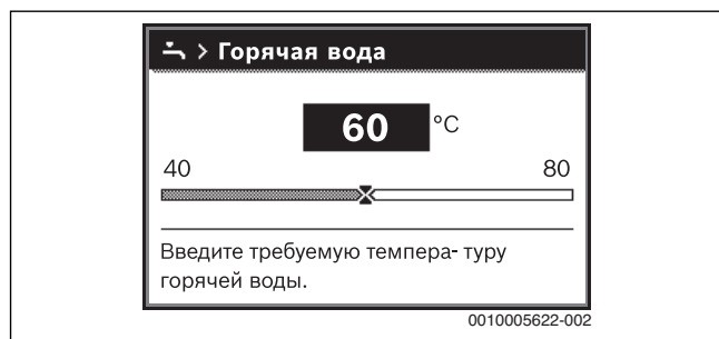
Рис. 27 Установка максимальной температуры горячей воды
