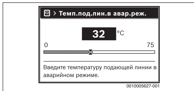
Рис. 42 Температура подающей линии для аварийного режима
