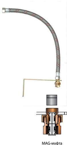
Позволяет быстро смонтировать на стене небольшой расширительный бак диаметром до 440 мм. В комплект входит гибкий шланг Ду 20 мм (длиной 700 мм) в оцинкованной оплётке, угловой кронштейн, быстроразъёмная MAG-муфта с подключением расширительного бака - НГ 3/4" (позволяет быстро снять бак без его опорожнения и слива системы отопления), комплект дюбелей.
