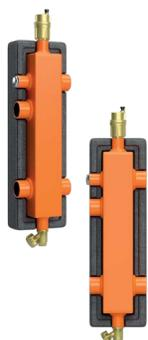
**Гидравлический разделитель ECO2 HW** - устройство для гидравлической развязки первичного и вторичного контуров в системах отопления и охлаждения. Позволяет организовать работу котельной установки, её высокий КПД работы, исключает взаимное влияние контуров (насосов), помогает конденсационным котлам выходить на максимальную мощность и обеспечивает им длительный срок эксплуатации.
