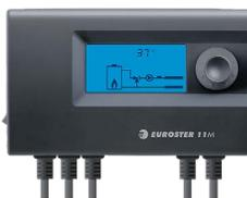
Предназначен для управления сервоприводом ST (арт. 66341) смесительного контура по заданной температуре (термостат). Имеет два режима работы "контроль подающей линии" и "контроль обратной линии", также контролирует включение насоса по заданной температуре. Имеет функции аварийного режима, анти-стоп (предотвращение блокировки смесительного клапана). Имеет возможность подключения комнатного термостата.
