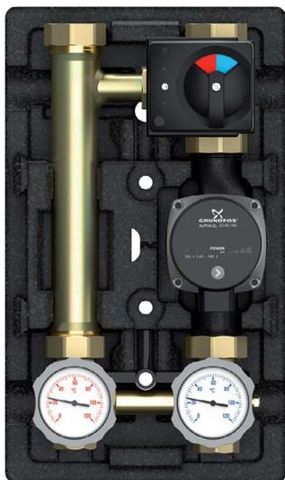
**Область применения:** смесительный контур, который автономно (по установленному электронному термостату) поддерживает постоянную температуру обратной линии. Используется в качестве защиты стальных и чугунных котлов от низкотемпературной коррозии.
