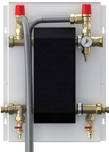
Теплообменник из нержавеющей стали в теплоизоляции (PU-утеплитель с PS кожухом), смонтированный на оцинкованной плите, с передним стальным декоративным кожухом (покрашен в белый цвет). С первичной/вторичной стороны оснащен предохранительными клапанами на 3бар (с отводами сброса из гофрированной нержавеющей трубы), подключениями расширительных сосудов, кранами для слива и заполнения контура. По вторичной стороне смонтирован манометр 4 бар.
