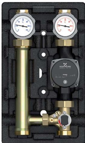
**Область применения:** смесительный контур, т.е. контур, в котором необходимо держать определённый температурный график за счёт подмеса охлаждённого теплоносителя обратной линии в подающую. Чаще всего используется в качестве контура “тёплого пола”, радиаторного отопления с точным управлением температуры и т.п. Для автоматического осуществления подмеса необходимо выбрать соответствующий электропривод и подключить его к управляющей автоматике.
