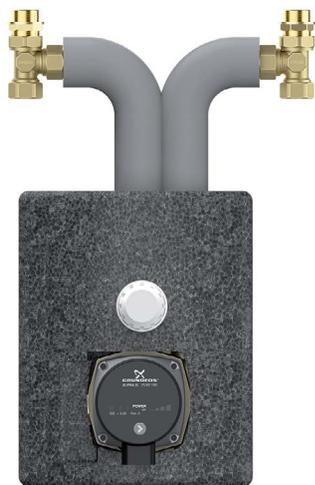
**Область применения:** контур "теплого пола" для автономной работы под настенным котлом (температуру контролирует жидкостный термостат с капиллярным датчиком, диапазон регулирования 25-50 °С).
