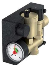
В изделие входят: предохранительный клапан 1/2" x 3/4", давление срабатывания - 3 бара, манометр, автоматический воздухоотводчик, негорючая термоизоляция. Подключение к котловому контуру - ВР 1/2". Для котлов до 85 кВт.
