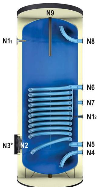
Ёмкость из стали S235JR со змеевиком косвенного нагрева, покрытая изнутри высококачественной стеклоэмалью с добавлением титана (в соответствии со стандартом DIN 4753-3), предназначенная для приготовления горячей воды от внешнего источника.
