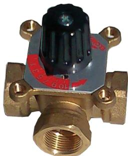
3-х/4-х ходовые смесители для перемешивания (перенаправления) потоков теплоносителя. Перемешивание может регулироваться либо в ручном режиме, либо при помощи сервомоторов под управлением соответствующей автоматики. Материал смесителей - латунь CW617N UNI EN 12165. Рабочий диапазон температур: +2 °С ...+110 °С (+130 °С кратковременно). Pn -10 bar
