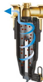
Шаг 2: Отложение загрязнений на сетке фильтра.
