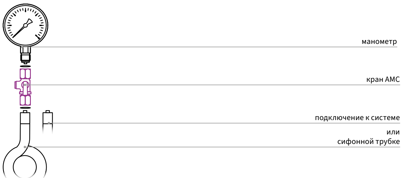
1. Измерение напора циркуляционного насоса (разница давления между всасывающей и напорным патрубками).
